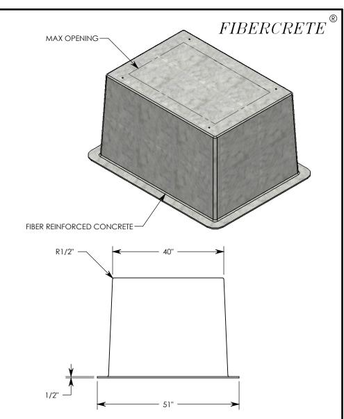
NOTE 1: Ø 1/2"-13 UNC LIFTING INSERTS WILL BE CAST INTO BOX PAD
